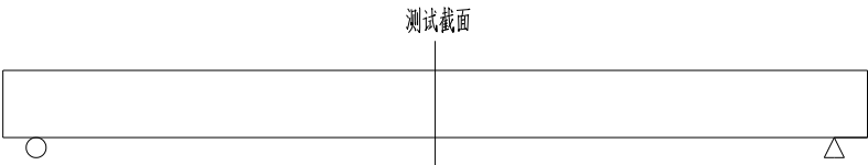
图 1 静载试验应变测试截面
