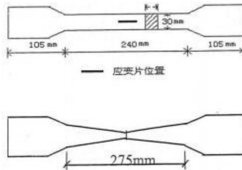
41 、现有一钢结构工程，设计要求钢材的屈服强度不低于 300MPa ，强屈比不小于 1.2，请某检测公司进行检测，由于该公司拉力试验机力值数据显示存在问题，所以采用了贴应变片进行钢材力学性能拉伸试验，荷载-变形曲线如下图所示。已知纵坐标上 A 点为拉伸曲线弹性阶段的任意一点 a 对应的力值点，C 点为下屈服点 c 对应的力值点，D 点为最大荷载点 d 对应的力值点，从拉伸试验曲线纵坐标上可获得  $OA: OC: OD= 100: 142: 228$  ，试验加载到 a 点时实测试件两侧平均应变值为  $1200 \mu \epsilon$  。（钢材的弹性模量取值  $206 \times 10^3 \text{ N} / \text{mm}^2$  ）
