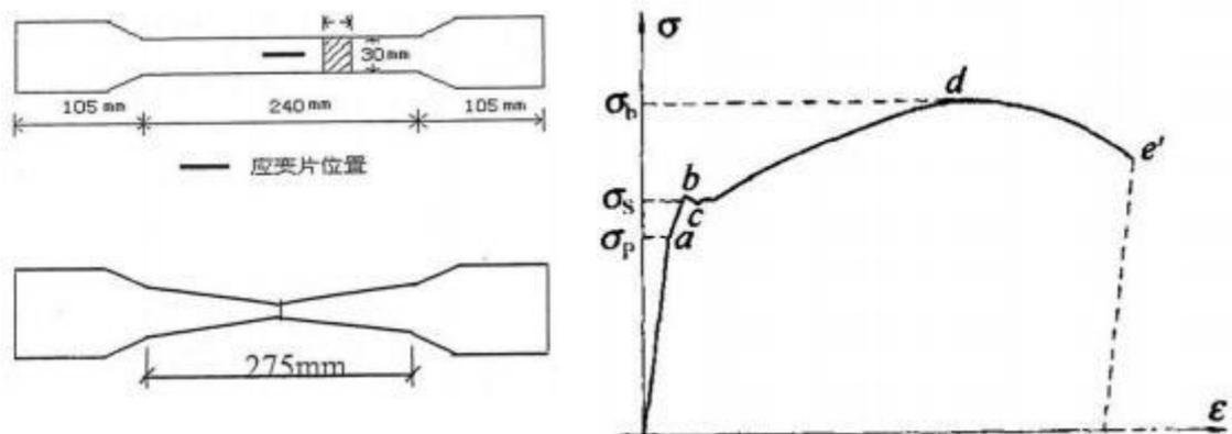
42、直径为 6mm 的圆形试样，当比例系数  $k=11.3$ ，求：原始标距取值，仲裁试验平行长度取值，试样总长度取值。
