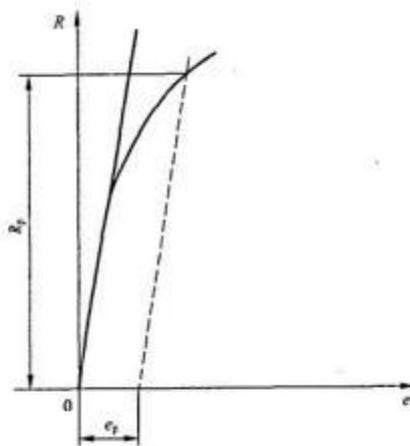
48、测试某钢材规定塑性强度  $R_{p0.2}$ ，机加工圆形横截面试样名义直径为 10mm，应力-延伸率拉伸曲线如下图所示。分别在标距的两端及中间三处相互垂直的方向测量直径，算术平均值分别为 9.96mm、10.03mm、10.04mm，规定塑性延伸率为 0.2% 对应的力值为 23.25kN，计算  $R_{p0.2}$ 。（ $\pi$  取 3.14）
