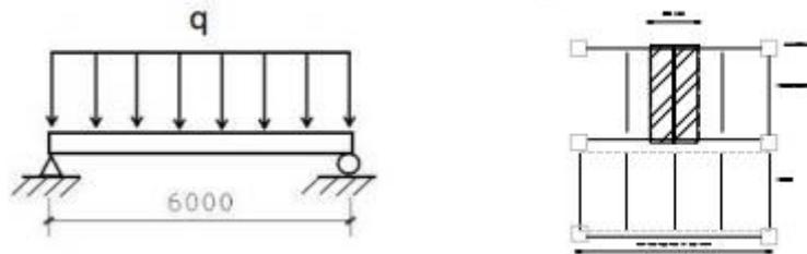
14、某学校教学楼楼面梁局部平面布置及次梁计算简图一如下，教室开间 12m，次梁跨度为 6m，次梁上线荷载设计值为  $40\text{kN/m}$ ，次梁选用工字形截面，净截面抵抗矩为  $W_x=690\text{cm}^3$ ；弯矩所对应的截面塑性发展系数  $X$  为 1.05，钢材为 Q345，假定可保证次梁的整体稳定，次梁与主梁连接为铰接。计算：次梁跨中弯矩正应力值接近为多少？
