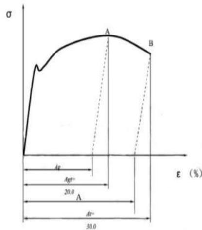
47、测试某钢材规定塑性强度  $R_{p0.2}$ ，机加工圆形横截面试样名义直径为 10mm，应力-延伸率拉伸曲线如下图所示。分别在标距的两端及中间三处相互垂直的方向测量直径，算术平均值分别为 9.98mm、10.02mm、10.02mm，规定塑性延伸率为 0.2% 对应的力值为 21.55kN，计算  $R_{p0.2}$ 。（ $\pi$  取 3.14）
