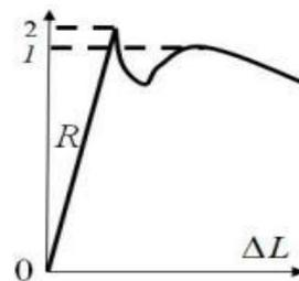
372、图中低碳钢拉伸曲线的 1、2 两点,判断正确的是（ ）。
