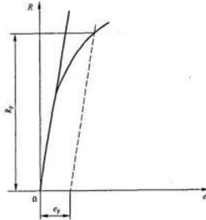
49、采用水平线法测试屈服点延伸率如下图所示，采用准确度为 1 级标距为 100mm 的引伸计，上屈服点测得引伸计伸长量为 0.15mm，不连续屈服阶段最后的最小值点测得伸长量为 0.80mm，求屈服点延伸率  $A_e$ 。
