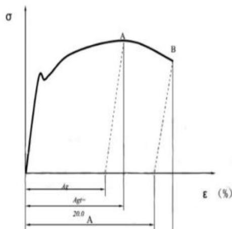
46、某钢材实测弹性模量为 200GPa， $\sigma - \epsilon$  曲线如图所示，A 点的应力为 550MPa，B 点的应力为 378MPa。计算断后伸长率 A，按照 GB/T 228. 1-2021 标准进行修约。（假定弹性部分的斜率值与弹性模量值非常接近）
