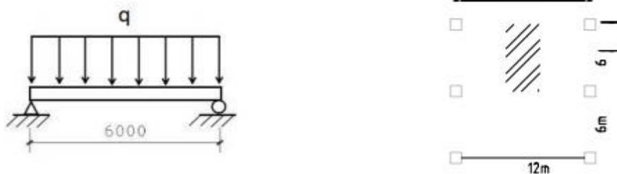
15、一根受弯工字形钢梁，梁跨中弯矩  $M_x$  为  $180\text{kN}\cdot\text{m}$ ，弯矩所对应的截面塑性发展系数  $X$  为 1.05，弯矩所对应的净截面模量  $W_{nx}$  为  $720\text{cm}^3$ ，计算梁跨中弯曲正应力。
