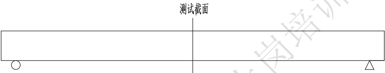
图 1 静载试验应变测试截面
